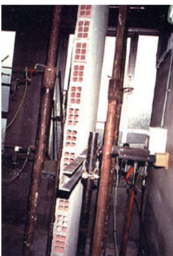
Fig. 4 - Prova su pannello tipo -9- (vista laterale).
