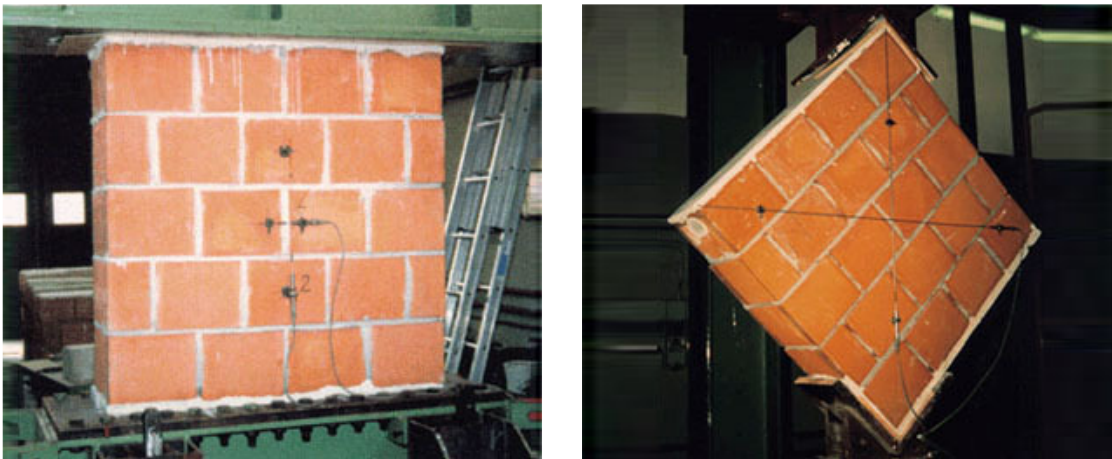
Fig. 6 – Prova di compressione in direzione parallela ai fori (a) e diagonale (b).
