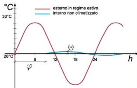
Fig. 4 - Smorzamento e sfasamento dell'onda termica.
