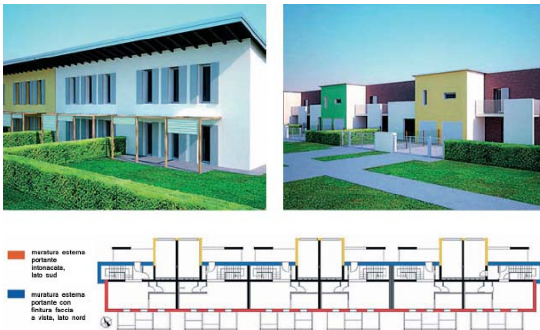
Fig. 1 - Vista dell'edificio bioclimatico a Pieve di Cento (BO) di "Ricerca e Progetto Galassi, Mingozzi e Associati in Bologna". In pianta si evidenzia la differenziazione delle murature in funzione dell'orientamento.
