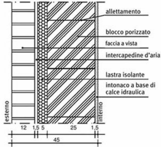
Muratura esterna portante con finitura faccia a vista, lato nord
