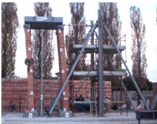
Fig. 4 - Ricerca DISWall: prove fuori piano di muri alti.
