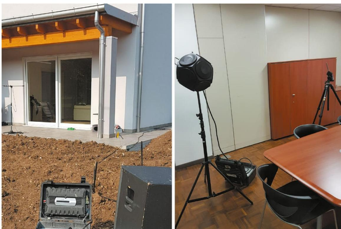
Fig. 1 – Misura in opera dell'isolamento acustico normalizzato di facciata (sx), misura in opera dell'isolamento acustico normalizzato di una partizione  $D_{nT,w}$  (dx)
