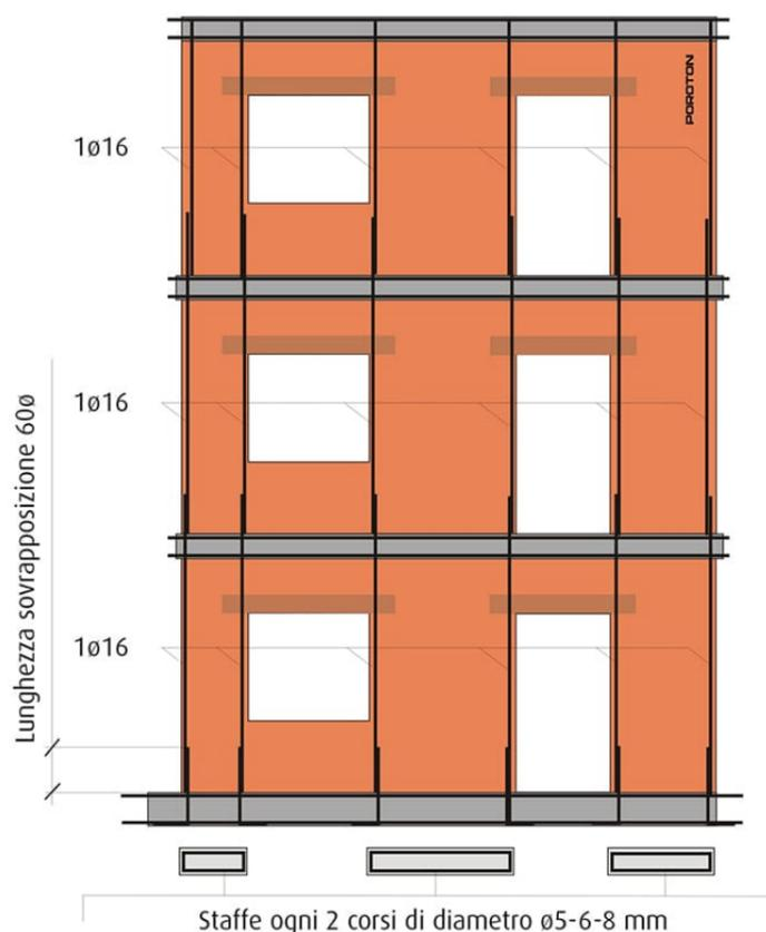
Fig. 6 – Disposizione generale delle armature con dettaglio della sovrapposizione delle armature verticali (tratta da *Capitolo 6 – Documentazione Tecnica POROTON®*).
