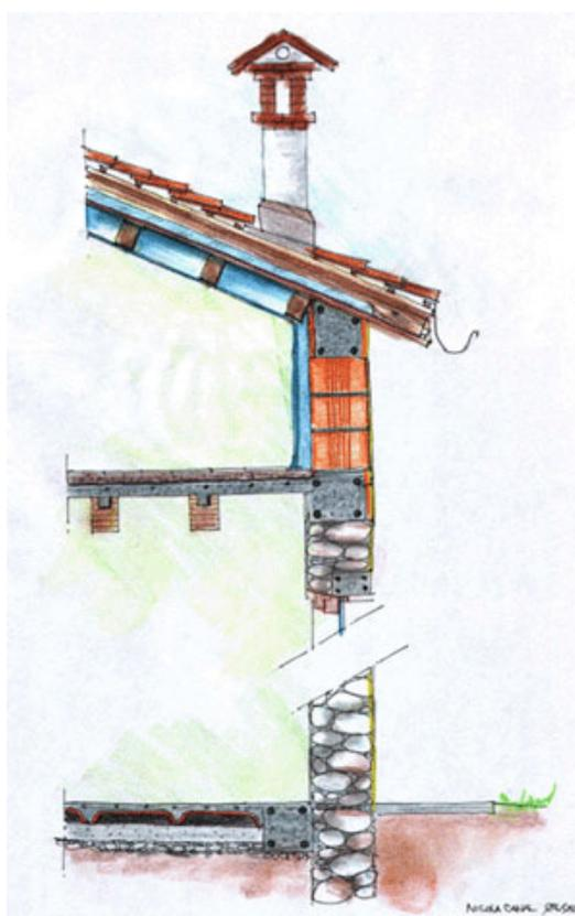
Fig. 2 - Ipotesi con solaio del sottotetto in struttura mista legno-calcestruzzo.
