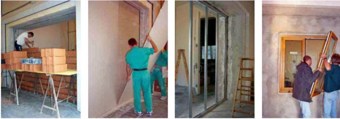
Fig. 2 - Installazione di diversi tipi di elementi edilizi all'interno dell'apertura di prova di un laboratorio per la misura del potere fonoisolante conforme alle prescrizioni della norma UNI EN ISO 140 parte 1.
