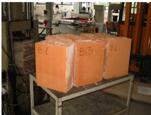
Fig. 3 - Catalogazione e rilievo delle dimensioni dei blocchi.
