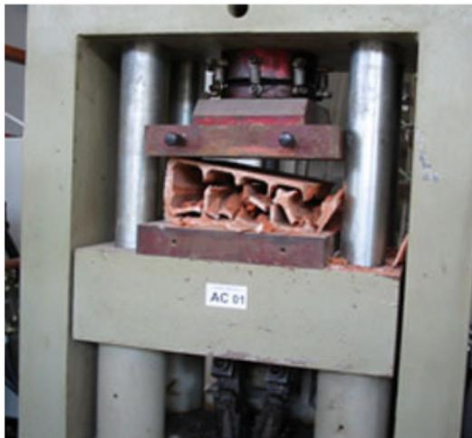
Fig. 5 - Rottura del campione B1.
