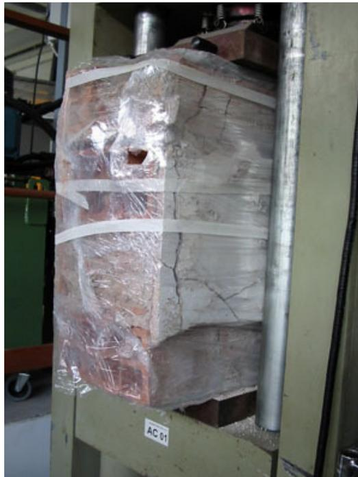
Fig. 8 - Il muretto al termine della prova.
