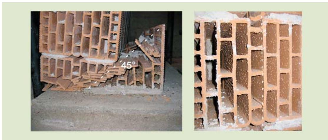
Fig. 4 - Rottura del corso inferiore nel campione FOA1 (a); deformazione e rottura del corso superiore nel campione FOB2 (b).
