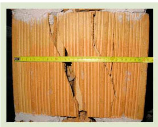
*Fig. 7 - Rottura del campione FVC1: vista generale e dettagli.*
