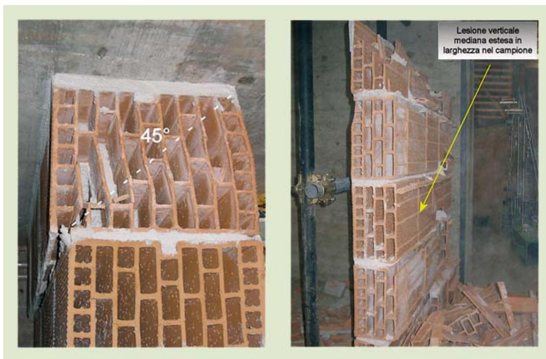
Fig. 5 - Lesione verticale in sezione: particolare (a) e dopo la demolizione del campione FOA3 (b).
