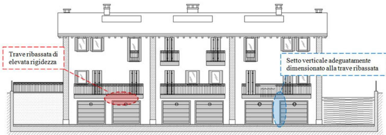
Fig. 1 - Esempio di edificio con piano interrato in c.a. avente aperture dei garage e struttura in muratura portante soprastante.
