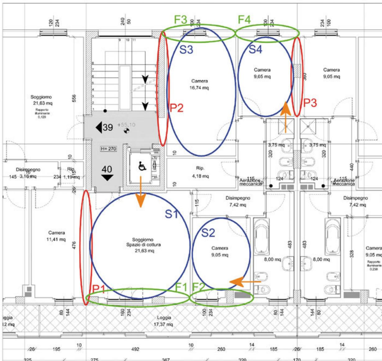
Fig. 1 - Alloggio tipo per esemplificare il procedimento di classificazione acustica dell'unità immobiliare.
