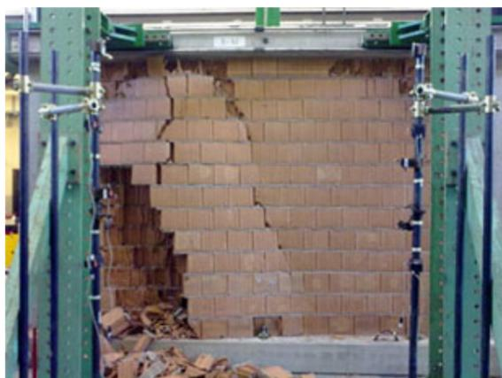
*Tamponatura antiespulsione non armata precedentemente danneggiata nel piano fino all'1.2% di drift (campione 3-IU)*
