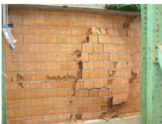
*Tamponatura antiespulsione armata precedentemente danneggiata nel piano fino all'1.2% di drift (campione 5-RIU)*
