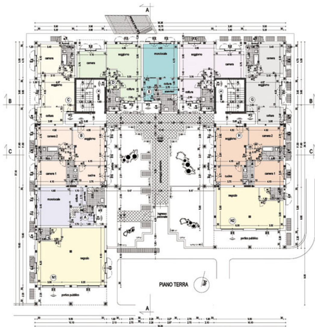
Fig. 2 - Pianta del piano terra del Lotto A.
