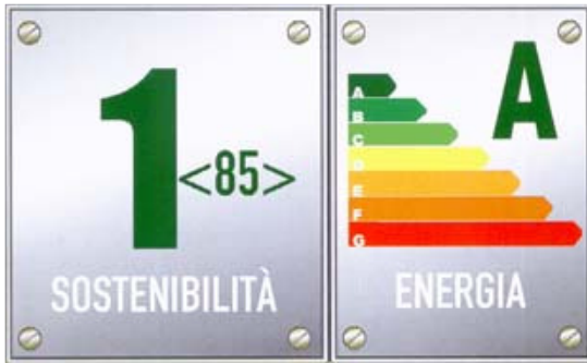
Fig. 3 - I risultati conseguiti dall'edificio nell'ambito del sistema di valutazione energetico ambientale SB100 sono riassumibili in una targhetta in cui appaiono contemporaneamente sia la classe di consumo energetico che il punteggio complessivo che esprime la qualità ambientale dell'edificio.
